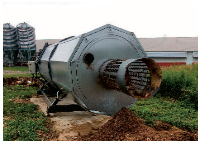
Le composteur, à partir des animaux morts, produit un compost au bout de deux jours après avoir effectué des rotations.
