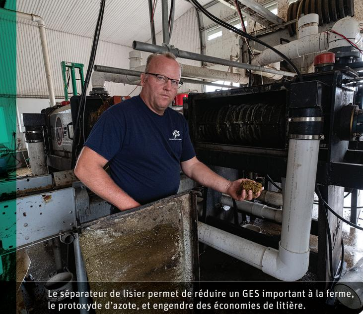
Le séparateur de lisier permet de réduire un GES important à la ferme, le protoxyde d'azote, et engendre des économies de litière.
