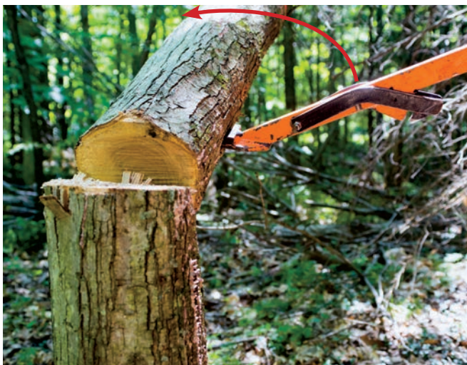
Pour dépendre un arbre encroué, on le tourne avec le crochet tourne-bille du levier d'abattage. Si le diamètre de l'arbre est trop grand pour le crochet, le bûcheron effectue une entaille dans l'arbre avec sa scie et y insère la pointe du levier d'abattage (photo de droite).
