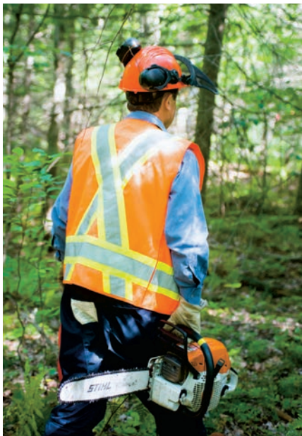
Lorsqu'il se déplace, le bûcheron tient la lame de sa scie vers l'arrière. S'il trébuche, celle-ci ne le blessera pas au visage.
