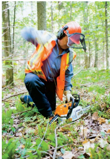
Lorsque le moteur est froid, on démarre la tronçonneuse au sol en plaçant un pied dans la poignée arrière et une main sur la poignée tubulaire. Quand le moteur est chaud, le démarrage s'effectue debout en mettant la poignée arrière entre les genoux.
